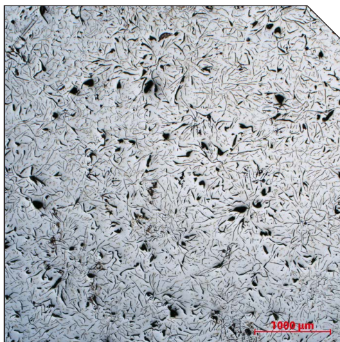
Obr. 5 - Rozložení lupínků grafitu u litiny s lupínkovým grafitem, kotouč TruBlue. Zvětšení 25x.
